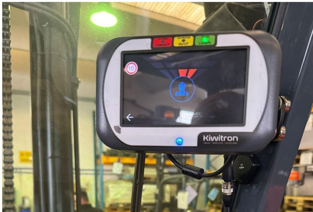
tinuo dei parametri per verificarne i consumi reali. Connesso al gestionale in cloud KiwiSat, KeyTouch consente la telemanutenzione, la teleassistenza e l'attivazione delle funzionalità del mezzo da remoto. "Tutte le funzionalità di KeyTouch sono integrabili sul gestionale in possesso del cliente in modo semplice e gratuito - assicura Bertaglia - Noi
