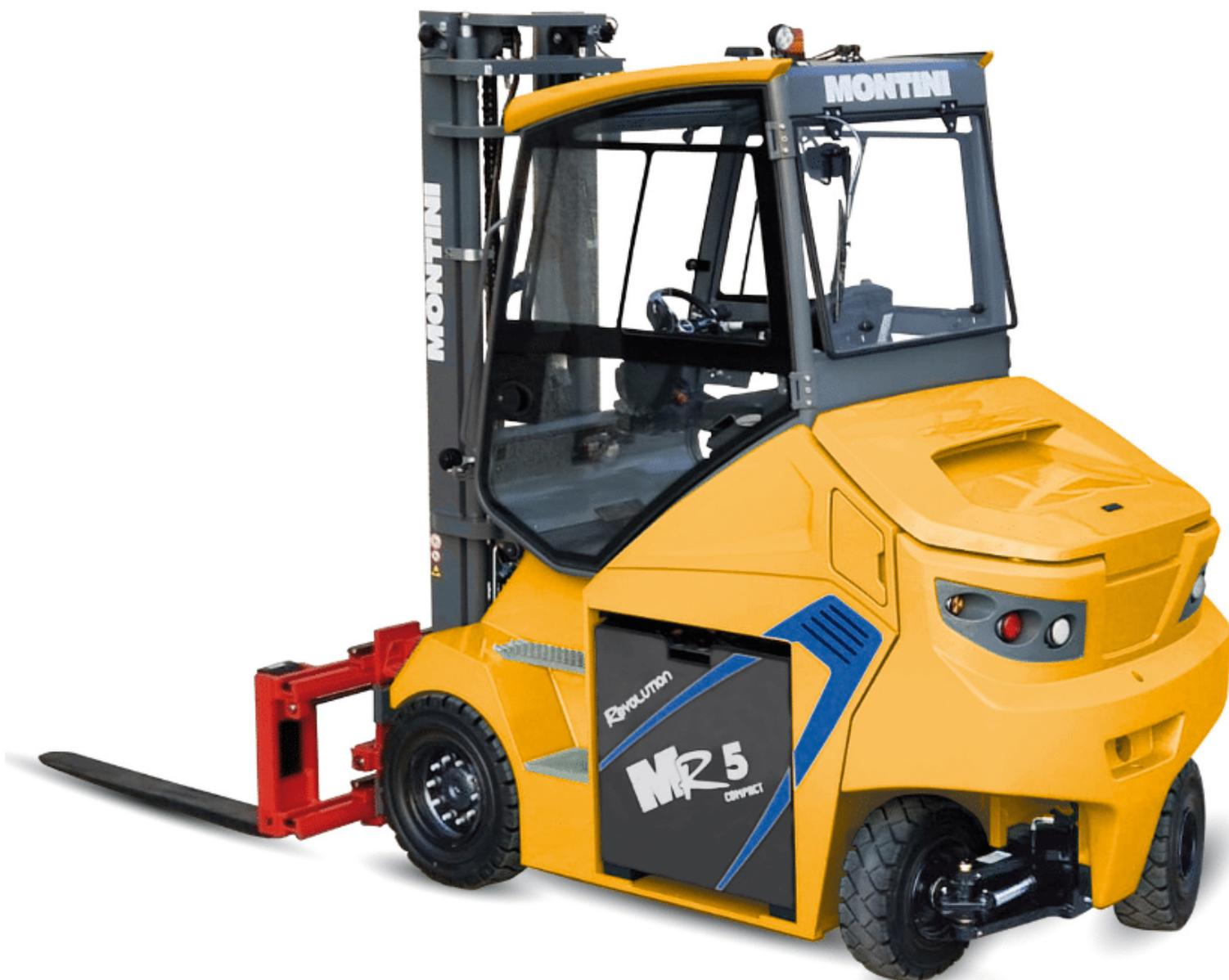
inverter da 96V con comunicazioni in CAN-bus, questi modelli heavy duty rispondono reattivamente alle richieste operative del mercato, in virtù dei gruppi di sollevamento configurabili con attrezzature specifiche supplementari per ogni necessità (in particolare pinze per bobine, posizionatori a forche multiple e speroni per coils).
